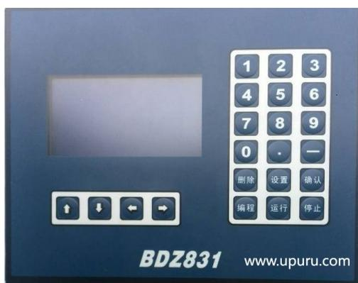
以上为面板按键，〈0-9〉为数字键；〈.〉为调整钻头上下按键；〈-〉键预留；〈删除〉在达到产量后按此键清零；〈设置〉在主画面时按此键进入参数设置；〈确认〉按此键对当前步进位置和当前电流等参数进行确认保存；〈编程〉在主画面时按此键，钻头可直接移动到表面深位置；〈运行〉按此键可将主画面变为运行待命状态；〈停止〉在系统工作时按此键紧急复位，在参数设置时退出到上一个画面；〈上下左右〉为移动键。
