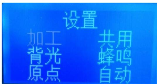
在此画面时按上下左右键可移动到各个需要设置的参数上，再按〈确认〉键进入到里面进行具体的参数设置。
