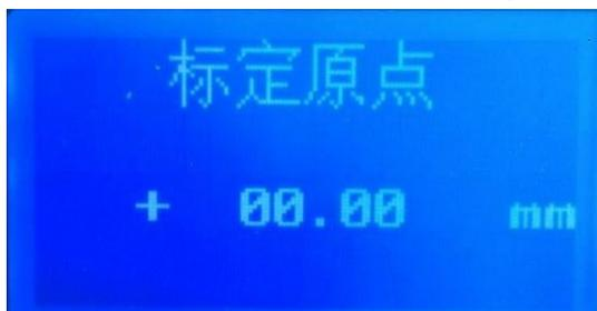
在此画面时按〈确认〉键表示即确认当前钻头位置。如位置不对，可按〈上下〉键进行调整步进电机，调整到适当位置后按〈确认〉键进行确认，此时系统会将该位置保存并做为本系统中的原点。
