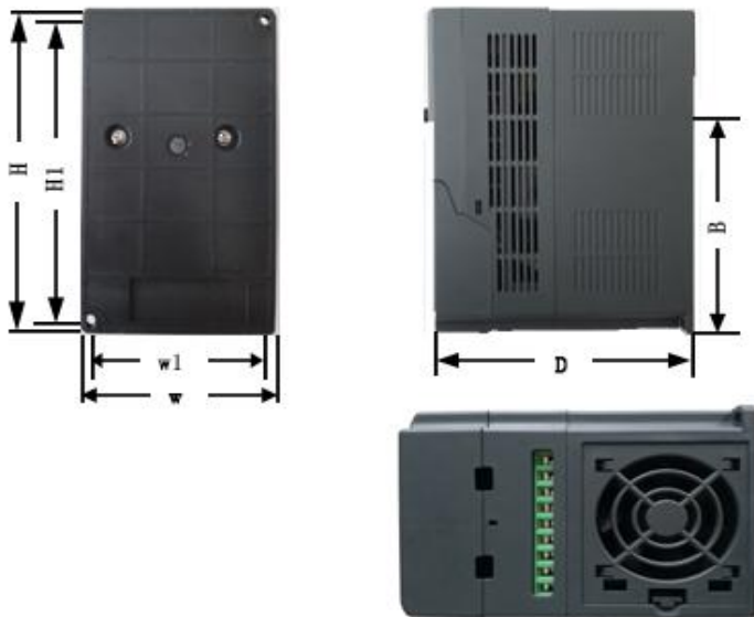
图 1-2 变频器外形尺寸及安装尺寸
